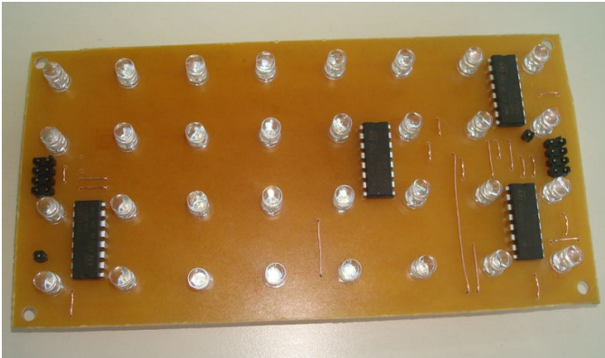
Figura 4: Módulo con los componentes soldados.
